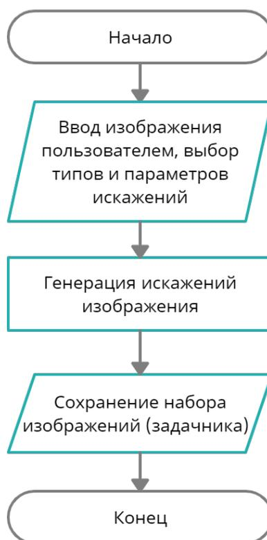
Рисунок 1. Блок-схема модуля генерации изображений
